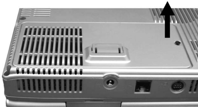
4. Retirez toutes les vis fixées au radiateur de dissipation de chaleur. Avant de retirer les vis, certaines mesures doivent être observées pour retirer le radiateur de dissipation de chaleur.
